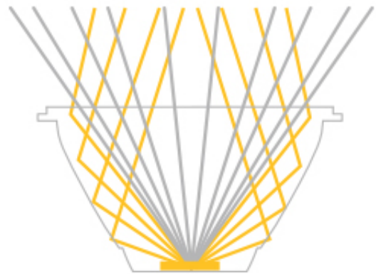
Lichtverspilling van traditionele Reflector
