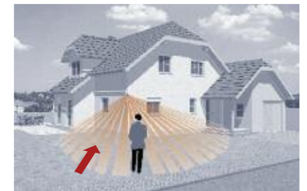
Radiale registratie – beweging direct naar de sensor toe (verminderde registratie t.o.v. nominale reikwijdte)
