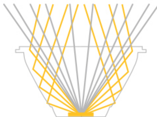
Lichtverspilling van traditionele Reflector
